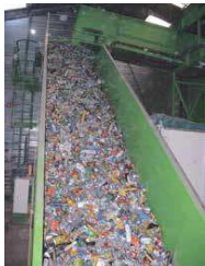
Le tapis roulant montant les déchets recyclables à la chaîne de tri manuel
