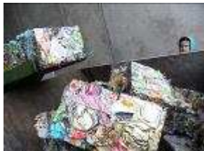
Acier compressé à la sortie de l'overband."
