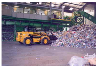
Télescopique qui pousse les déchets à recycler dans la plate-forme de tri
